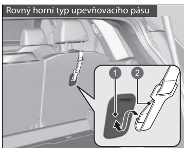
1 Ukotvení 2 Háček upevňovacího pásu
